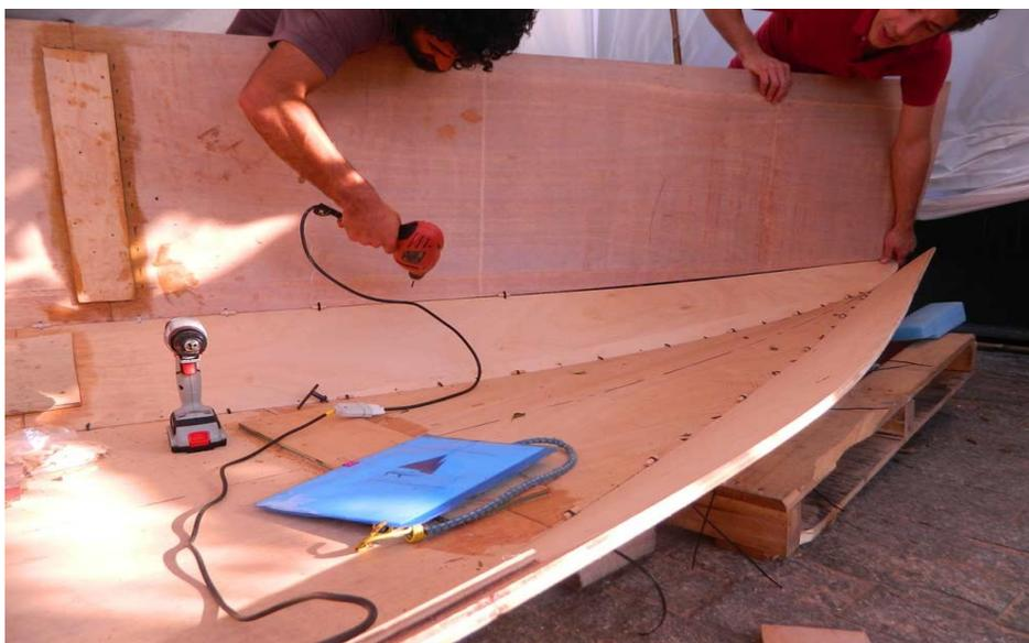
A próxima etapa é a filetagem. Você precisa criar uma transição arredondada, suave, de uma chapa para a outra, senão, ao colar a fibra de vidro, ela vai formar bolhas de ar e descolar da madeira antes de curar. Como a fibra não vinca, ela precisa de uma curvatura para acompanhar a transição de um painel para outro.
